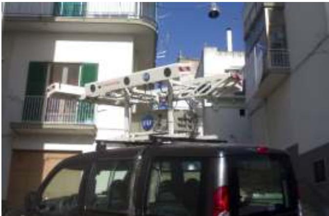
2. **Sistema di 9 fotocamere digitali Reflex ad alta definizione** tipo Nikon D80, dotate di sensore tipo CCD da 10,2 megapixel. Organizzate in 3 triplette - una frontale, una lato sinistro ed una lato destro del veicolo – consentono scatti ad altissima qualità ad una risoluzione massima di 3872 x 2592 pixel; forniscono l'immagine di uno
