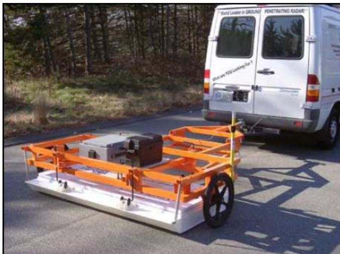
L'integrazione fra Terravision - che segnala il sottoservizio - e POS LV - che fornisce la posizione del veicolo - consente di definire la ubicazione del sottoservizio nello spazio e rende possibile la sua materializzazione su una planimetria della zona. L'integrazione fra Terravision e Z-Scan D fornisce l'informazione visiva del soprasuolo e l'esatta individuazione della tipologia del sottoservizio.
